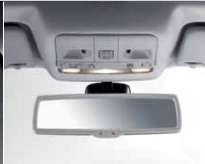
Незаслепящото вътрешно огледало за обратно виждане ви предпазва от заслепяване чрез автоматично потъмняване – сензор измерва интензивността
